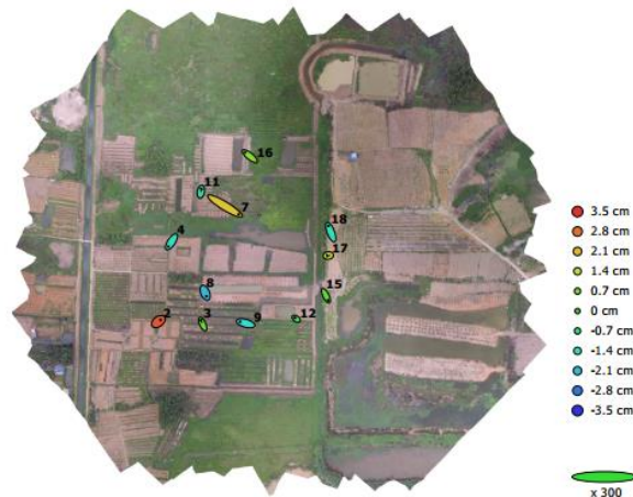
Hình 11. Điểm khống chế ảnh mặt đất và sai số ca bay 3
