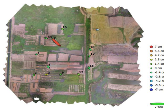
Hình 7. Điểm khống chế ảnh mặt đất và sai số ca bay 1.
