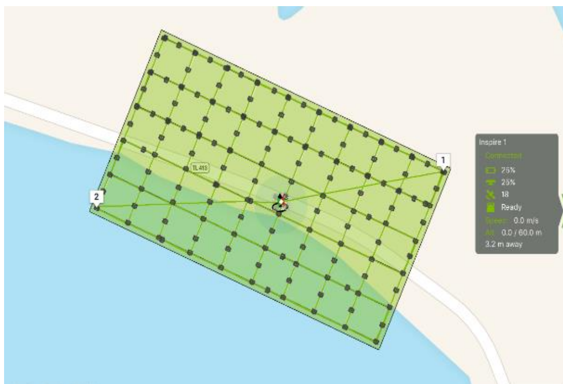
Hình 5. Sơ đồ thiết kế bay chụp ảnh phục vụ thành lập mô hình 3D.
