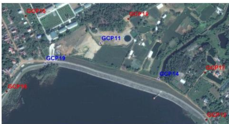
Hình 3. Bố trí điểm khống chế mặt đất (a); Tiêu đo khống chế (b).
