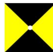
Tiêu được thiết kế với kích thước 50x50 cm
