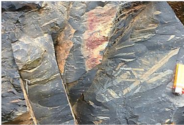
Ảnh 1. VL41. Sét kết màu đen có chứa hóa đá thực vật, bị biến chất tiếp xúc nhiệt.
