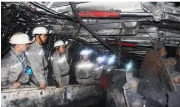
Hình 2. Máy khâu than tại lò chợ cơ giới hóa VM-L(7)-1.
