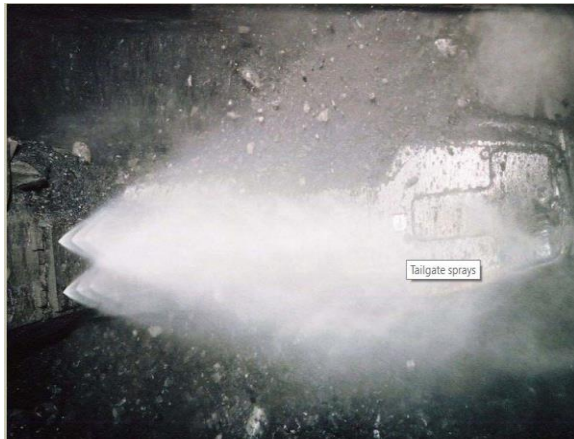
Hình 5. Phun sương từ hông lò chợ cơ khí hóa.
