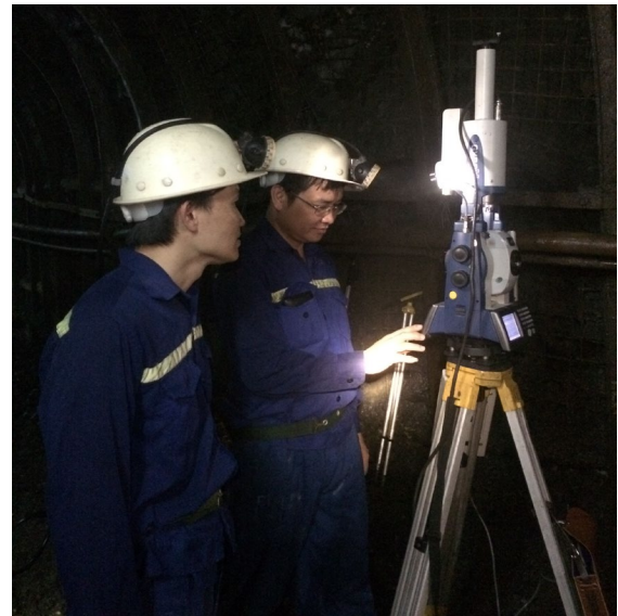
Hình 2. Máy kinh vĩ con quay GYRO X II trên trạm đo phương vị trong mỏ than Núi Béo.
