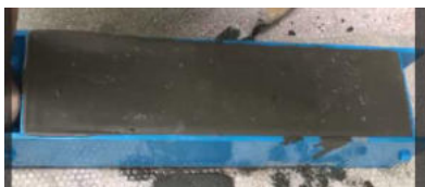
Pour concrete into the mold
