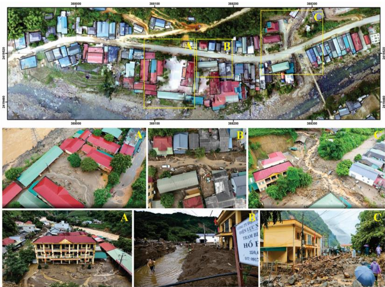
Hình 8. Vị trí dòng lũ bùn đá thực tế (A-Vùng thoát; B-Vùng di chuyển; C- Vùng bắt đầu tích tụ vật liệu).
