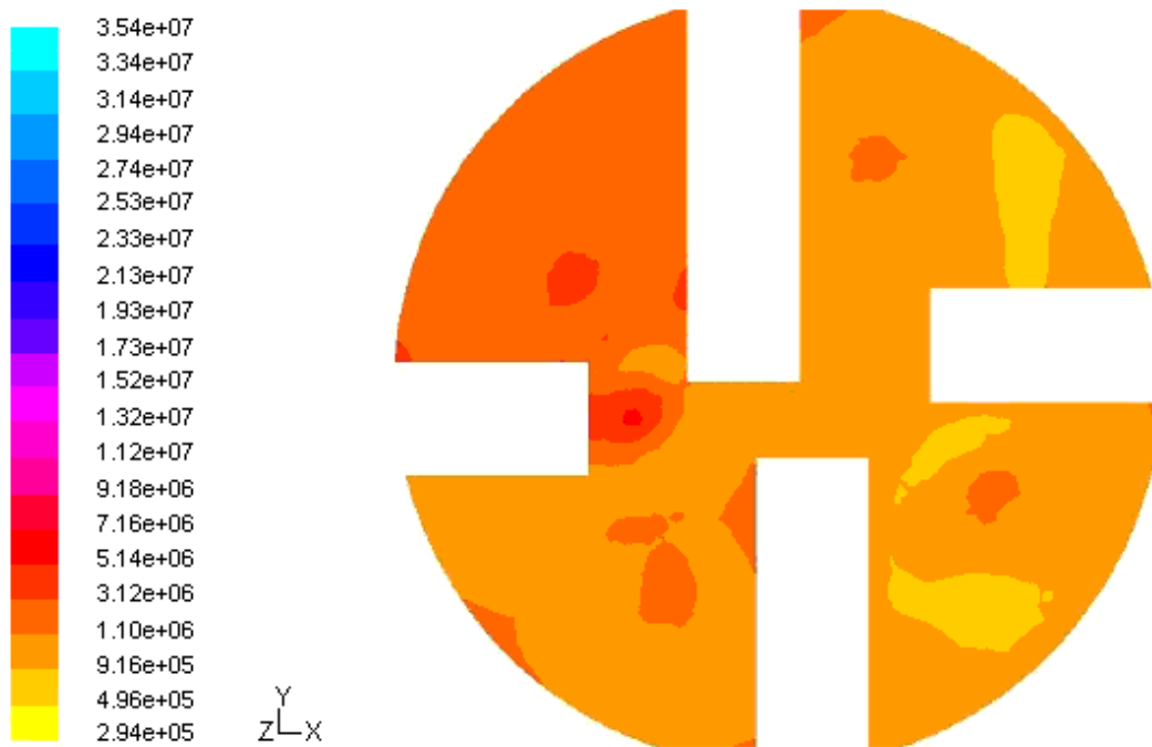
Hình 11. Sơ đồ phân bố trường áp lực của tổ hợp 5 vòi phun tại mặt cắt ngang đáy giếng
