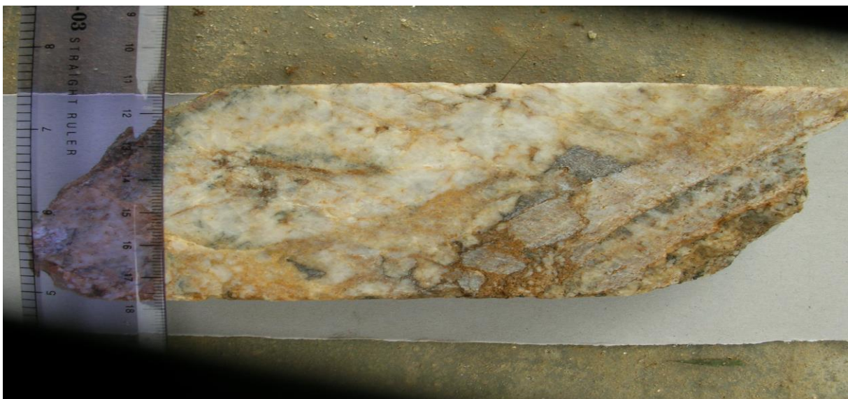
Ảnh 2. Quặng thiếc lấp đầy khe nứt trong đá hoa (đới quặng ĐQII)
