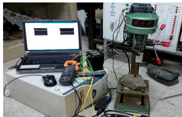
Hình 3. Mô hình thực nghiệm đo độ rung cho máy khoan Q&S trong phòng thí nghiệm.
