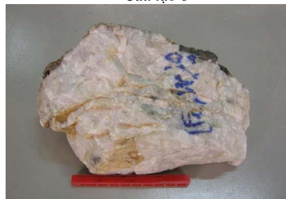
Ảnh 10. Quặng wolfram Thiện Kế - Tuyên Quang TPKVQ: Wolframit, pyrit. Cấu tạo mạch
