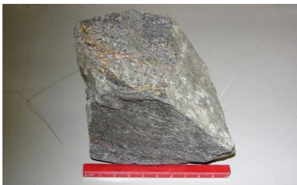
Ảnh 11. Quặng đồng Sin Quyền - Lào Cai TPKVQ: Chalcopirit, covelin, chancozin. Cấu tạo đặc sít
