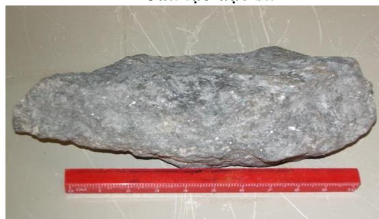
Ảnh 16. Quặng Sb Làng Vài-Tuyên Quang TPKVQ: Antimonit. Cấu tạo đặc sít
