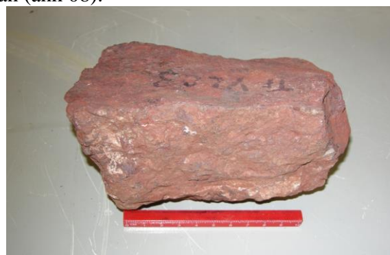
Ảnh 02. Quặng sắt Nà Rạ - Cao Bằng TPKVQ: Hematit, magnetit. Cấu tạo đặc sít
