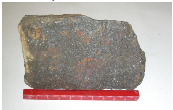
Ảnh 03. Quặng sắt Tùng Bá - Hà Giang TPKVQ: Magnetit, hematit. Cấu tạo đặc sít
