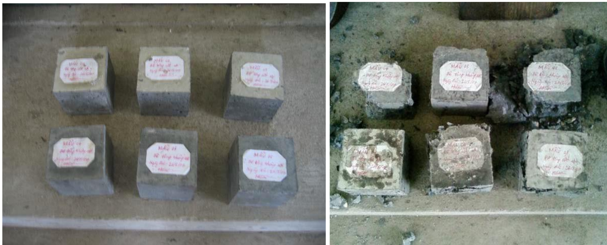
Hình 6. Mẫu bê tông 7 ngày tuổi trước và sau khi phá hoại
