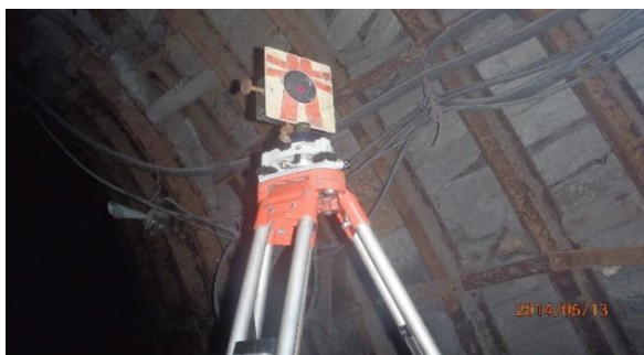
Hình 3. Bảng ngắm được thiết kế dùng cho đo laser với các vật liệu khác nhau trong hầm lò.
