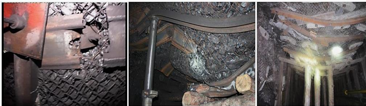
Hình 1. Hình ảnh thanh giằng bị phá hủy khi phối hợp chống giữ cùng neo (Vũ Đức Quyết, 2015).
