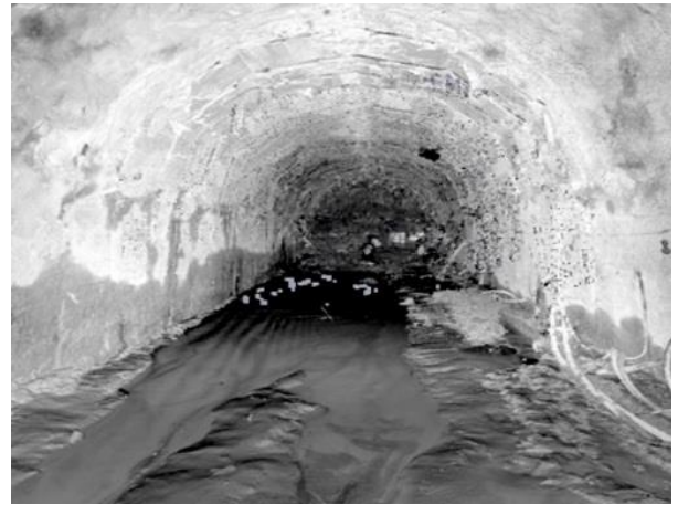
Hình 4. Dữ liệu đo bằng TLS tại đường hầm thủy điện Đa Dâng cho số lượng lớn các điểm
