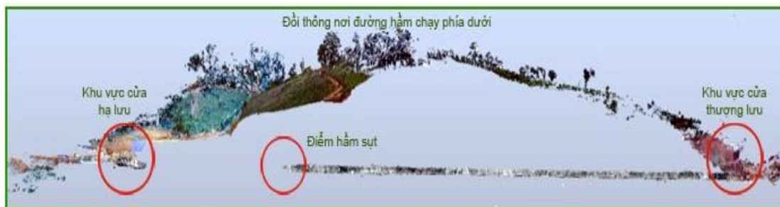
Hình 9.1. Mô hình 3D khu vực xảy ra sự cố sập hầm ( http://www.vinanren.vn/default.aspx?page=tmv_chitiectin&cat=news&zoneid=83&lang=vi&contentid=1911 )
