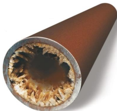
Hình 3. Tích tụ sa lắng muối trong ống khai thác (Crabtree et al, 1999).
