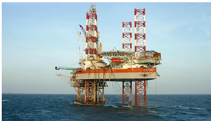
Hình 1. Giàn khoan tự nâng (1 - Chân đế; 2 - Các thanh giằng của chân giàn; 3 - Thanh răng; 4 - Hệ thống bánh răng).
